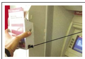
Fig.4 Ecco la microcamera
